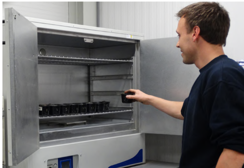
Paul Stroosma plaatst voor 24 uur grondmonsters in de oven om het vochtgehalte en volumegewicht te bepalen
